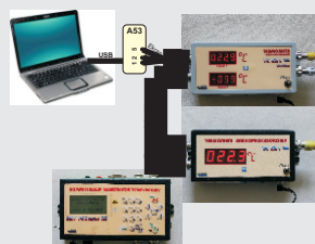
Sieć przewodowa RS-485 w magazynie
